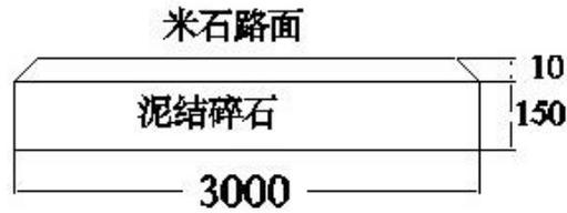
图 8-9 生产道路典型设计图 单位 (mm)
